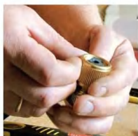
Ниппель идеально, с натягом, входит в разрез.
