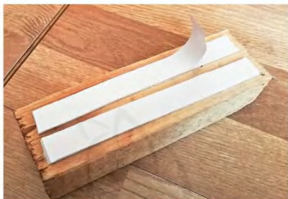
Соединяем скотч и брусок
