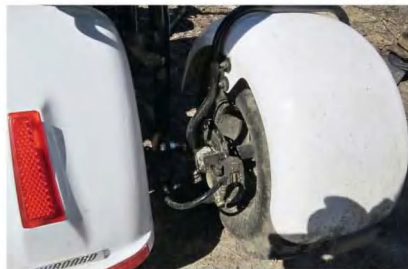
Тормоза у трайка дисковые, гидравлические.
